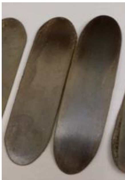
Рисунок 14 – Фотография пластин из ВТС с ЭФП после УЗО
