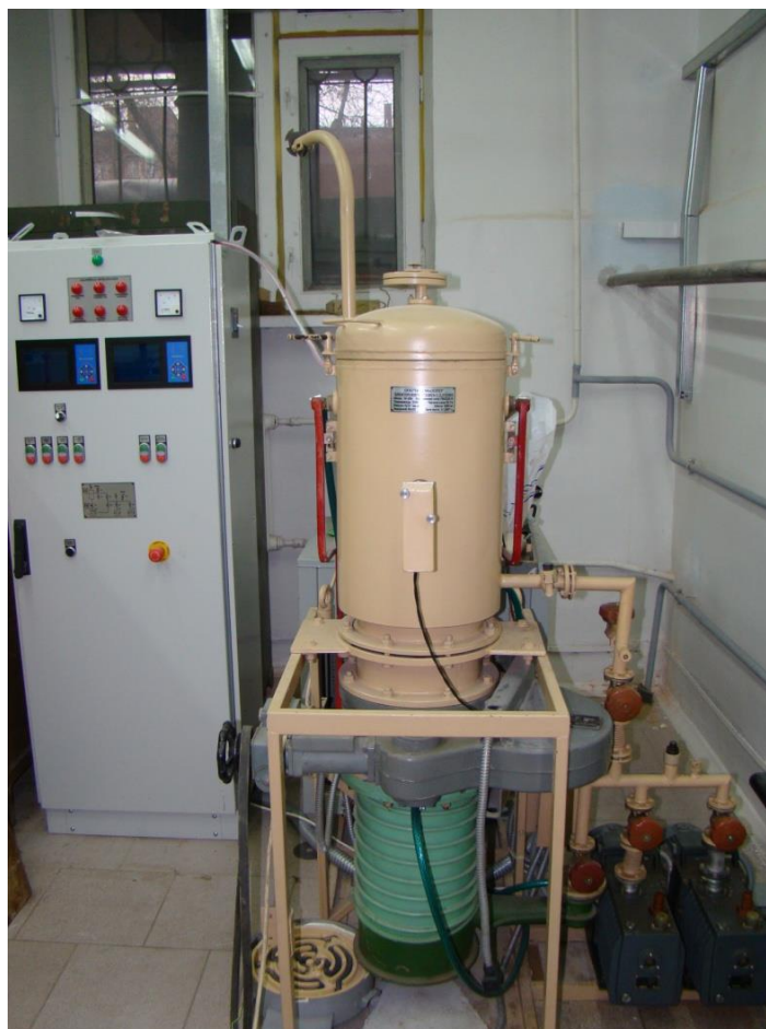
Рисунок 11 – Вакуумная электропечь сопротивления СШВЭ-1.2,5/25И4
