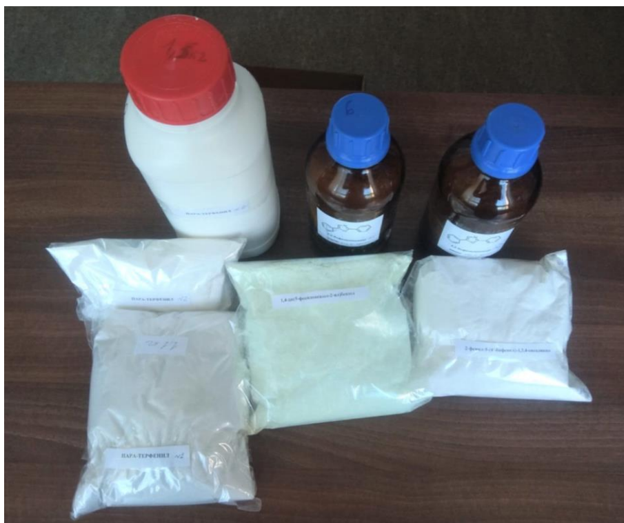
Рисунок 23 – Синтезированные опытные партии сцинтилляционных материалов
