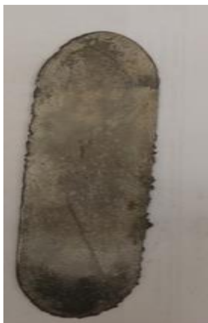
Рисунок 15 – Фотографии пластины после кислотного травления
