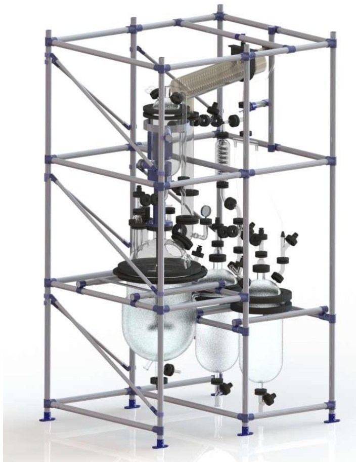
Рисунок 22 – Эскиз опытной установки, вид сбоку
