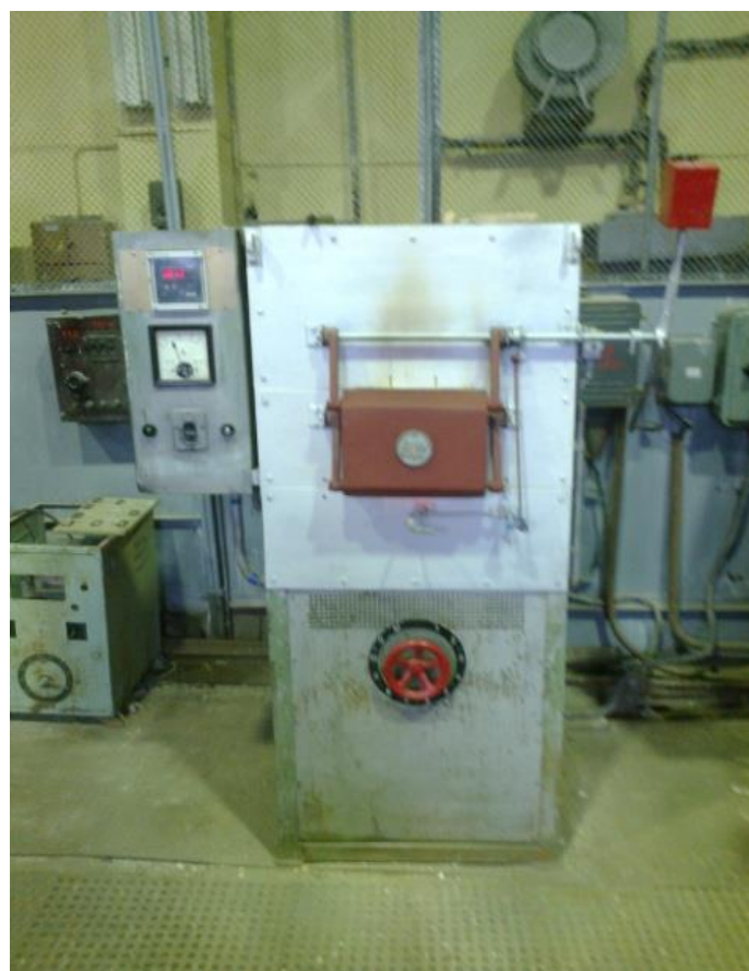
Рисунок 10 – Муфельная печь для нагрева образцов под прокатку
