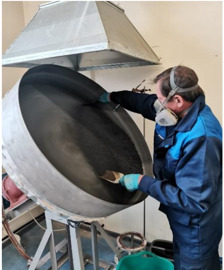
Рисунок 20 – Установка для переработки отходов магнитных материалов с получением оксидов РЗЭ
