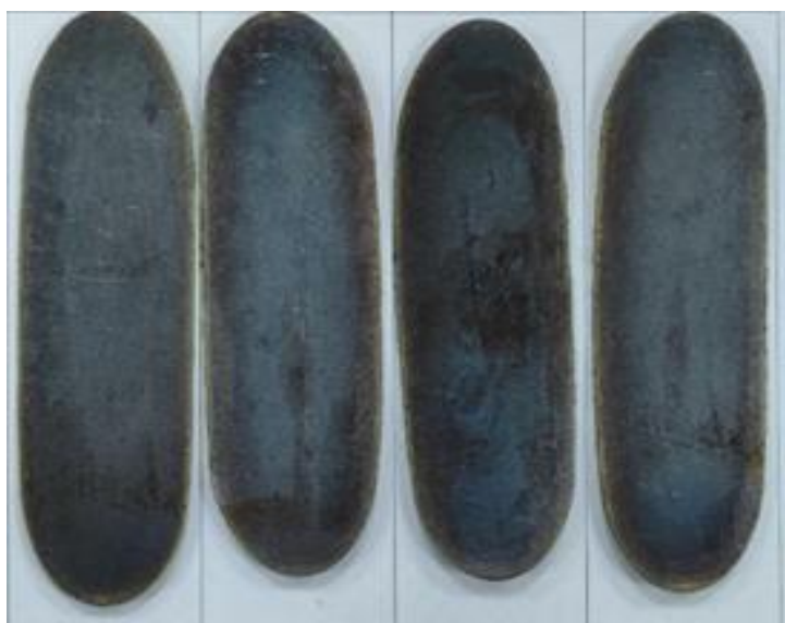
Рисунок 13 – Фотография пластин из ВТС с ЭПФ сплава состава Ti-Hf-Ni после горячей прокатки слитков
