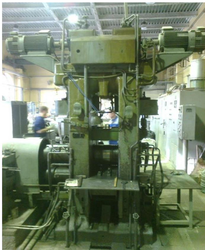
Рисунок 9 – Прокатный стан ДУО-300 (ГП)
