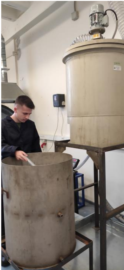
Рисунок 20 – Установка для переработки отходов магнитных материалов с получением оксидов РЗЭ
