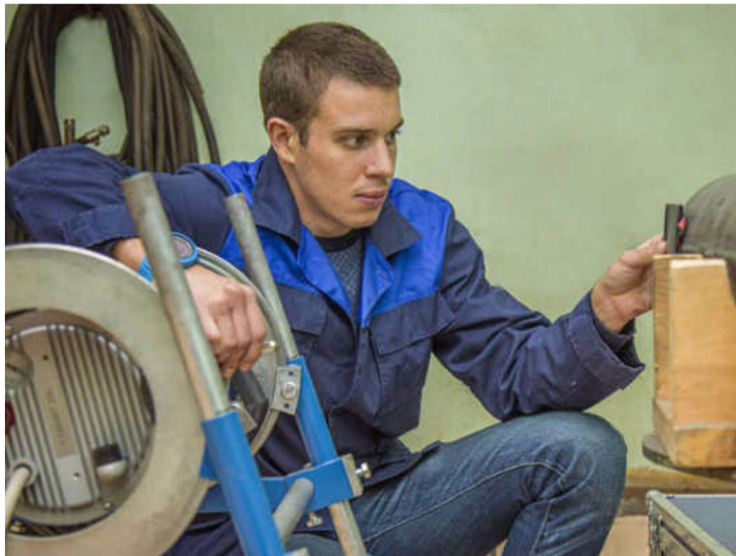
◀ Инженер Иван Столыпин проводит радиографический контроль готовых изделий
